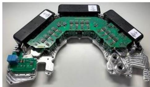
Antriebsumrichter für einen Radnabenantrieb
