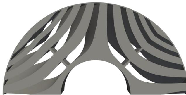
Abb. 1: Beispielmodell eines additiv gefertigten Synchron-Reluktanzrotors ohne Endbereichserweiterung
